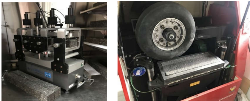
Figura 3. Equipamentos para ensaio de fadiga (flexão em 4 pontos) e deformação permanente ( Orniéreur ). Fonte: Silva (2018).
