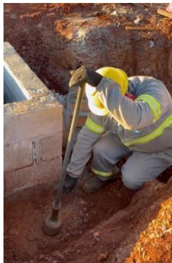
Figura 4 – Ensaio de cilindro de cravação (Autores, 2023).
