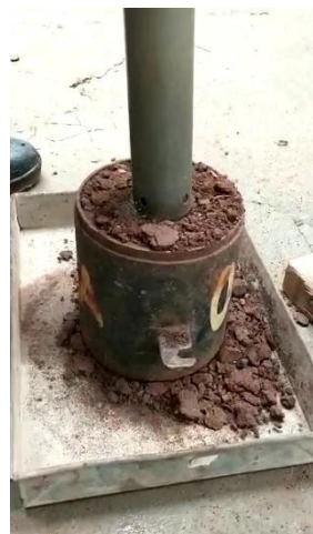
Figura 3. Corpo de prova sendo compactado no cilindro Proctor.
