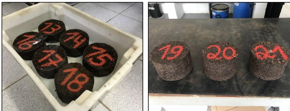
Figura 2. Corpos de prova ITS em imersão (à esquerda) e após concluída a cura controlada sem imersão (à direita).
