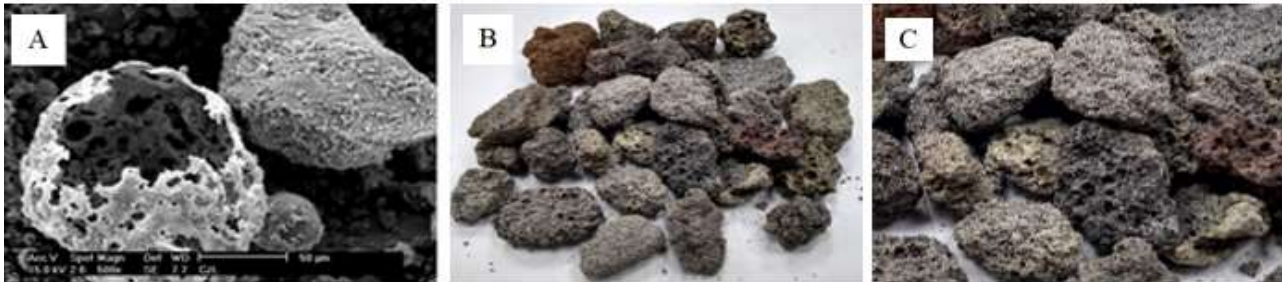
Figura 3. (a) MEV partículas presentes nas cinzas volantes (b) e (c) estruturas vesiculares ((a) IZIDORO (2013) (b) e (c) CLARA (2020)).
