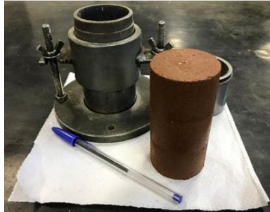
Figura 3. Molde tripartido utilizado para moldagem de corpos-de-prova (AUTOR, 2020).
