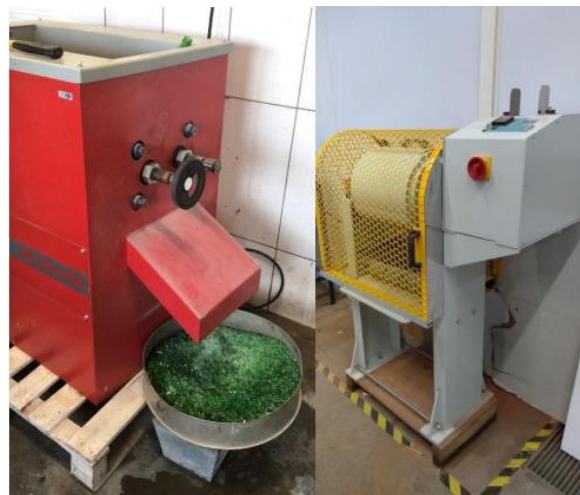
Figura 2: Equipamentos utilizados na trituração e moagem do vidro (AUTOR, 2020).
