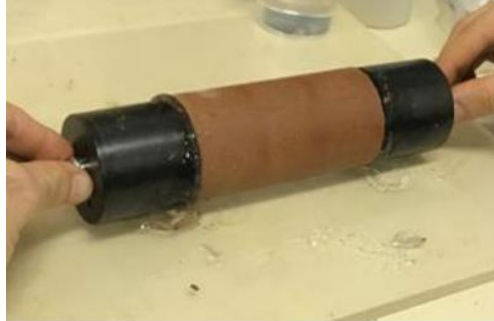
Figura 5: Medição do tempo de deslocamento de ondas de compressão (AUTOR, 2020).
