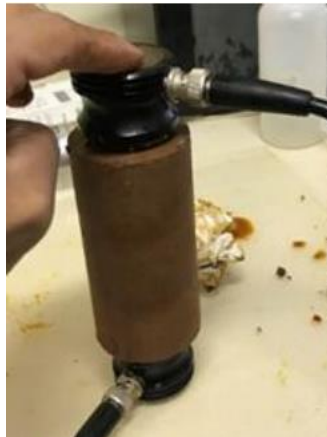
Figura 6: Medição do tempo de deslocamento de ondas de cisalhamento (AUTOR, 2020).
