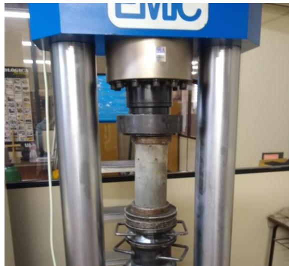
Figura 2. Corpo de Prova antes do rompimento.
