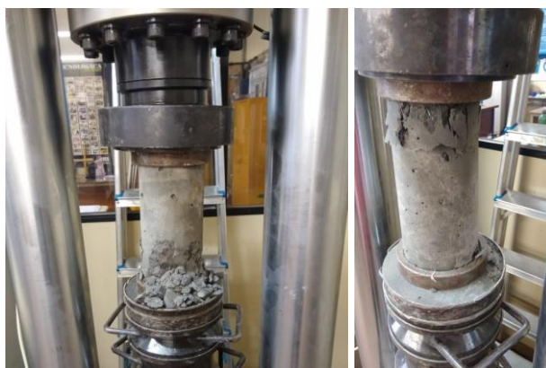
Figura 3. Corpo de Prova REF (a) e CRFA 20% (b) depois do rompimento.
