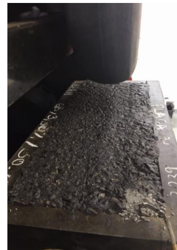
Figura 5. Visão geral do (a) afundamento na trilha de roda e, (b) do aspecto das misturas asfálticas GB 0/20 mm.
