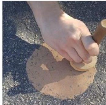
(b) Espalhamento da areia sobre a superfície
