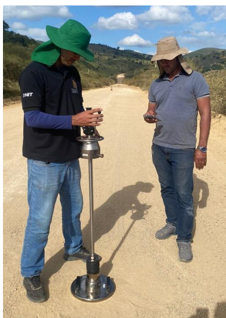
Figura 4. Levantamento com LWD na BR 030.
