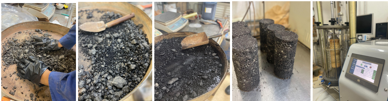
Figura 3. Procedimentos para ensaio de deformação permanente. a) Fase inicial de homogeneização; b) Fase intermediária de homogeneização; c) mistura final homogeneizada; d) Corpos de prova compactados; e) Corpo de prova sendo ensaiado (AUTOR, 2023).
