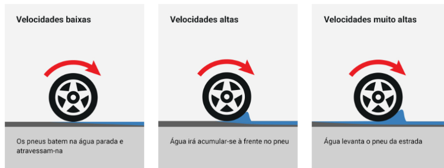
Figura 1: Fenômeno da hidroplanagem (Uniroyal, 2017)
