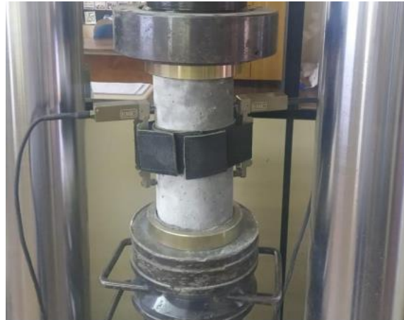
Figura 5: Corpo de prova no ensaio de módulo de elasticidade (AUTORA, 2021).
