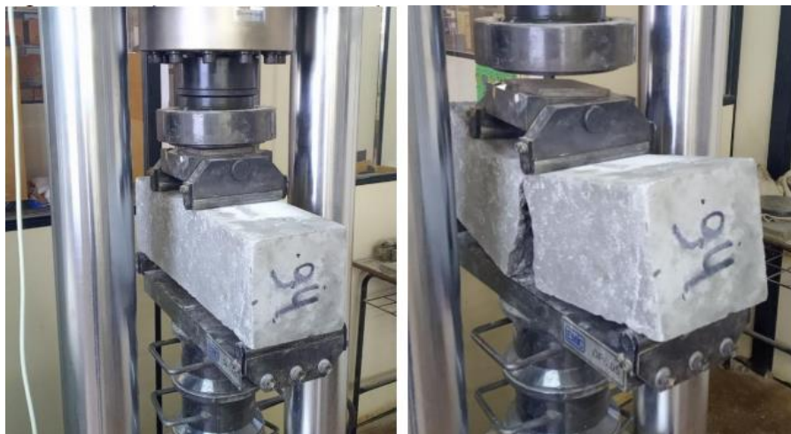
Figura 4: Corpo de prova no ensaio de tração na flexão. (AUTORA, 2021).
