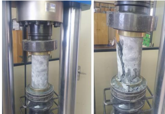
Figura 3: Corpo de prova antes e depois do rompimento. (AUTORA, 2021).
