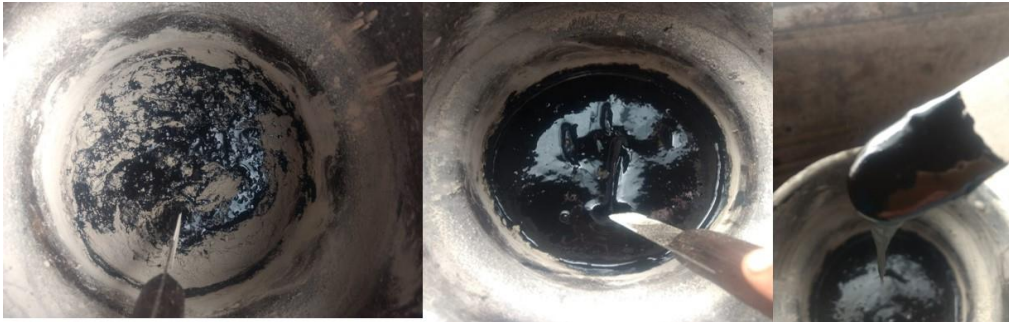
Figura 3. Incorporação do lodo têxtil no ligante CAP 50/70 (AUTOR, 2023).
