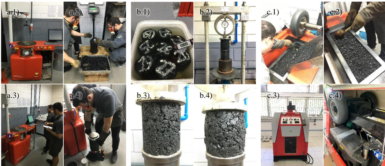
Figura 4. Sequência de ensaios realizados na pesquisa: (a.1, a.2, a.3 e a.4) PCG, (b.1, b.2, b.3 e b.4) Duriez a 18 °C, e (c.1, c.2, c.3 e c.4) deformação permanente a 60 °C (EVALDT, 2023).
