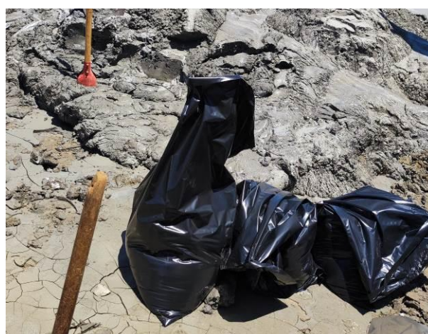
Figura 9. Sacaria com amostras de LBRO proveniente de tear com fio diamantado. (Autoria própria, 2023).
