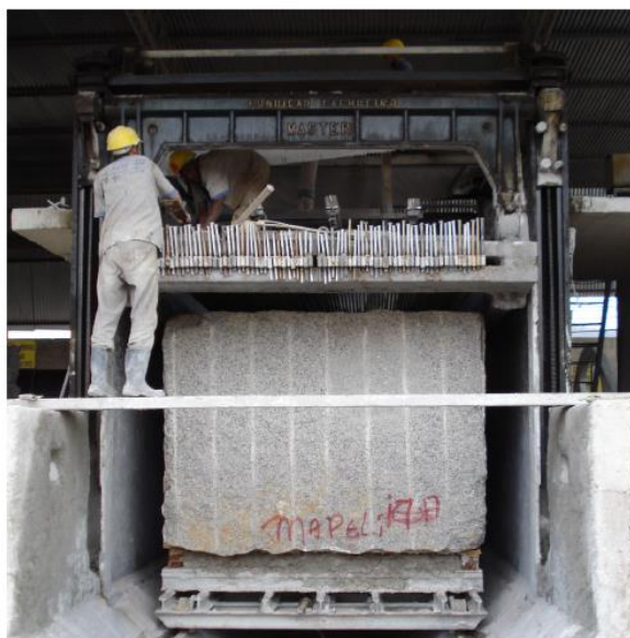
Figura 1: Processo de serragem dos blocos: a esquerda o Tear convencional, a direita o Tear multifio com fio diamantado. (Fonte Buzzi, 2008).
