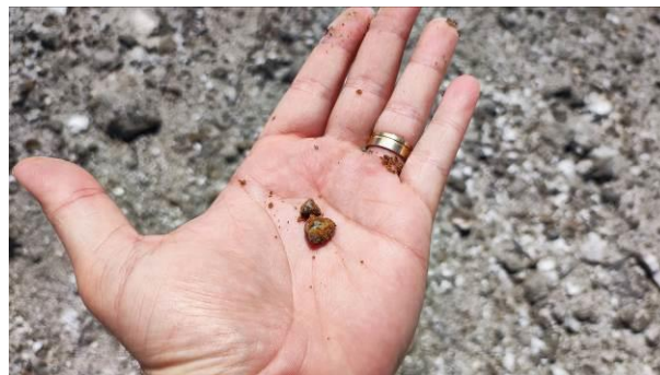
Figura 7. Partícula de LBRO de tear convencional oxidada. (Autoria própria, 2023).
