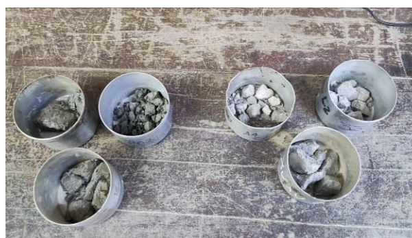
Figura 11. Amostras para ensaio de teor de umidade no laboratório do IFES. (Autoria própria, 2023).
