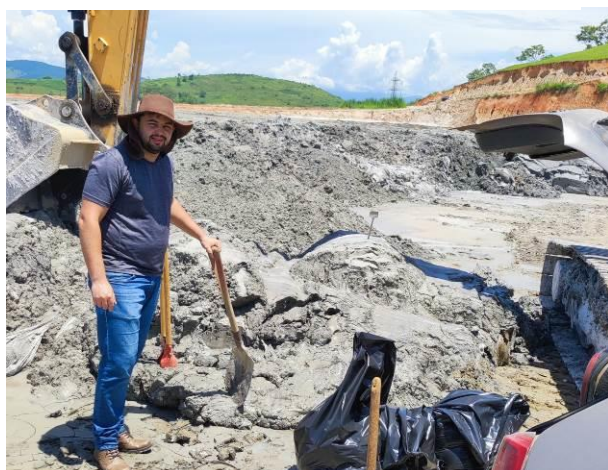
Figura 8. Coleta de amostras da pilha de LBRO proveniente de tear com fio diamantado. (Autoria própria, 2023).
