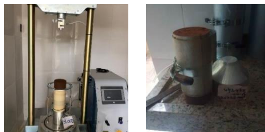
Figura 2. Equipamento utilizado para a realização do ensaio triaxial de cargas repetidas (AUTOR, 2023).
