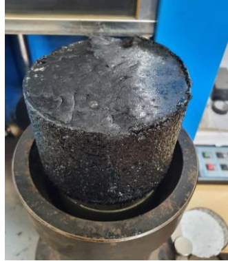
Figura 4. Excesso de ligante na superfície de um corpo de prova com péletes.
