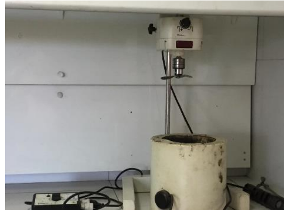
Figura 3. Agitador de hélice com câmara de aquecimento para modificação do ligante com pélete.
