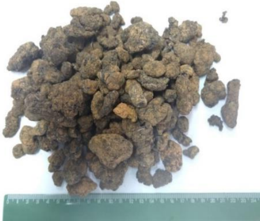
Figura 2. Amostra de péletes de asfalto-borracha utilizados nesta pesquisa - PelletPAVE-Plus (PPP) .
