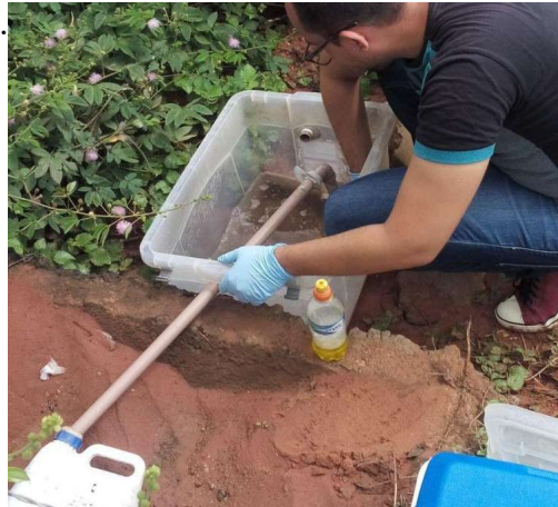
Figura 6 - Lavagem do coletor de água de rodovia (Autores, 2023).
