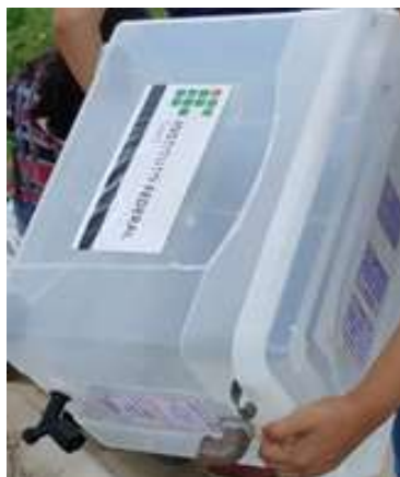
Figura 4 - Coletor de água utilizado na rodovia (Autor, 2023).
