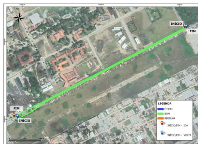
Figura 7. Resultados do SmartIRI obtidos para os subtrechos analisados (AUTORES, 2022)
