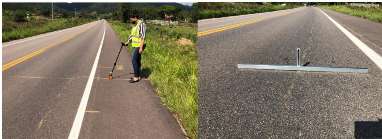
Figura 4: Marcação de medição da área trincada e medida do afundamento de trilha de roda
