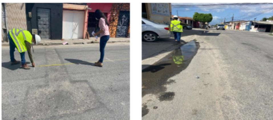
**Figura 2.** Aplicação do Método IGG nas ruas inspecionadas
