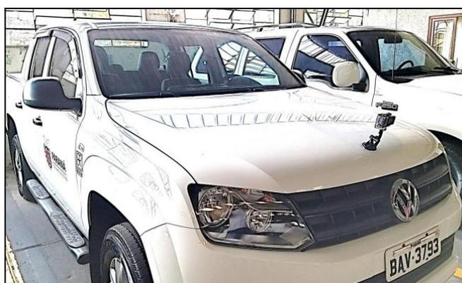
Figura 2. Veículo e equipamento utilizado pelo DER/PR para a captura das imagens georreferenciadas do pavimento em campo (OS AUTORES, 2022).
