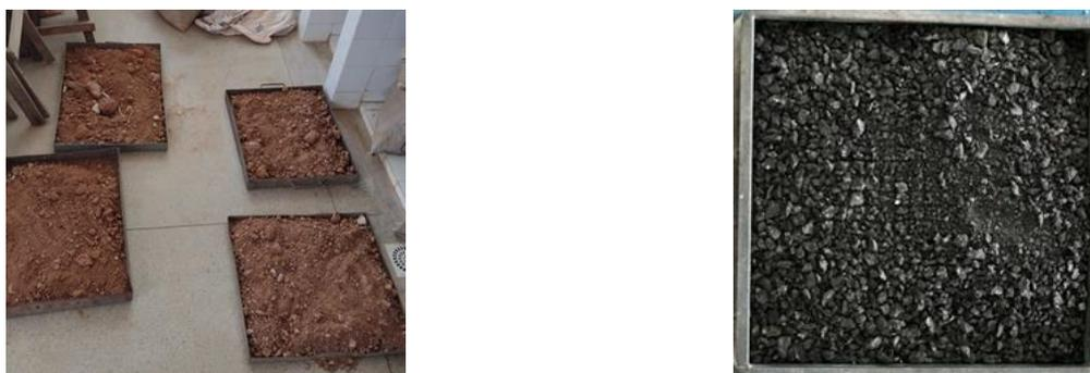
Figura 1. Materiais utilizados na pesquisa: solo (esquerda) e material fresado (direita)
