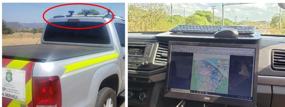
Figura 3. Veículo e equipamento automatizado para a realização do LVC (LVC, 2021).
