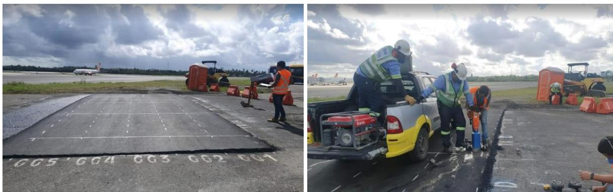
Figura 6 - Faixa teste segmentada em zonas homogêneas (*Tiles*) e extração dos corpos-de-prova (AUTORES, 2022).
