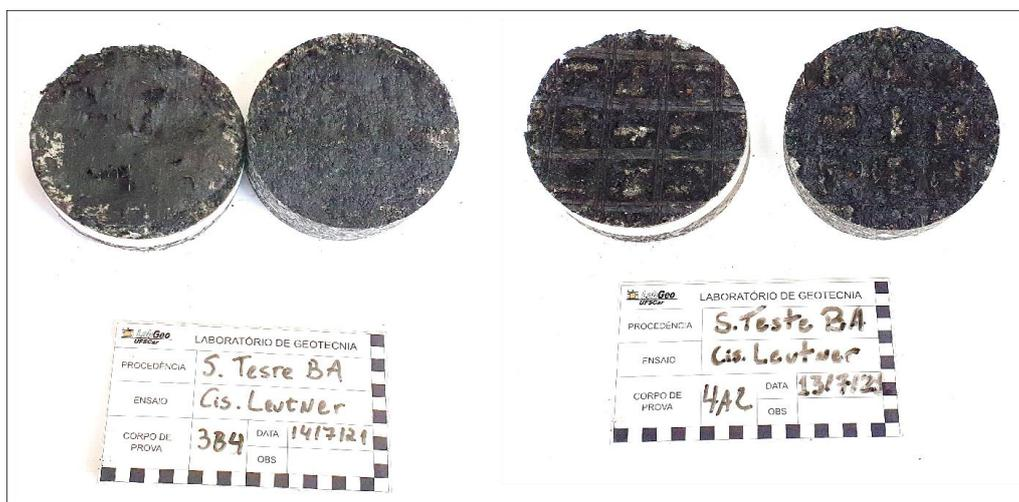
Figura 7. Exemplo de corpos-de-prova válidos após ensaio de cisalhamento que romperam na interface.
