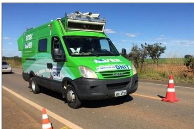
Figura 1. Exemplo de veículo equipado para a captura de imagens/filmes do pavimento (DNIT, 2020).
