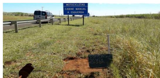
**Figura 9-** Coleta de material, areia laterítica quartzosa – LA, da região de Itaí-SP.
