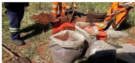
**Figura 7-** Coleta de material, areia argilosa – LA-LG', da região de Jaú a Barra. Bonita.
