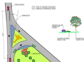
Figura 2: Representação Gráfica das Áreas de visibilidade desimpedida - AVD (DER/SP, 2005).
