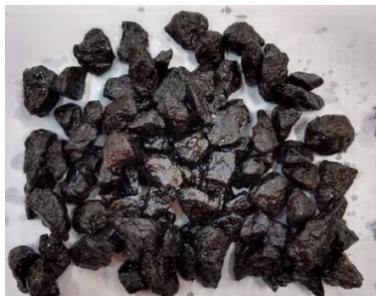
Figura 1 (c): Resultado do teste de adesividade para a mistura de PEAD20. (OS AUTORES, 2019).
