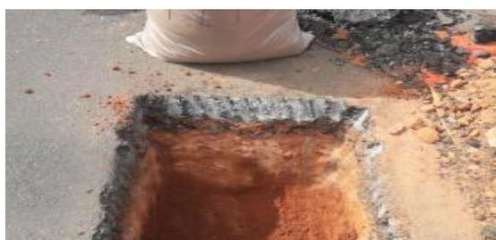
**Figura 8-** Coleta de material do tipo areia siltosa – LA-LA', da região de Jaú a Barra Bonita.
