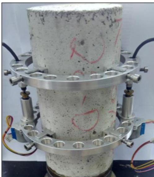
Figura 2 – Sistema de medição
