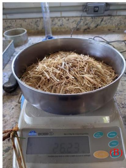
Figura 02. Fibra do buriti utilizada no experimento. (a) Modo comercial (b) Fibra cortada. (AUTORES, 2022)
