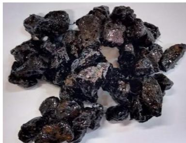
Figura 1 (b): Resultado do teste de adesividade para a mistura de PEAD10. (OS AUTORES, 2019).
