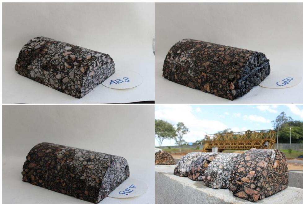
Figura 4. a) superior à esquerda: cilindro partido ao meio extraído da placa com mistura AB8; b) superior à direita: cilindro partido ao meio extraído da placa com Geogrelha; c) inferior à esquerda: cilindro partido ao meio extraído da placa de referência d) inferior à direita: corpos de prova serrados a partir dos cilindros partidos ao meio. Fonte: autores.
