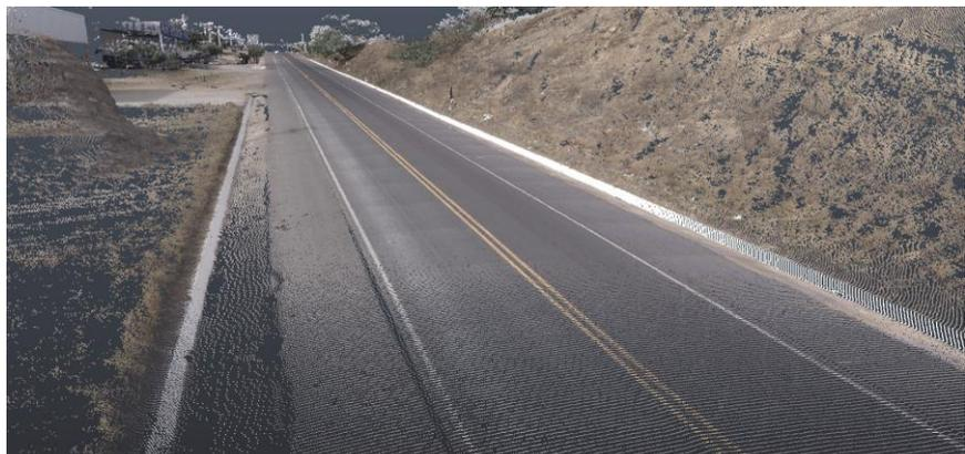
Figura 2. Imagem da nuvem de pontos obtida com o PEGASUS (Silva, 2021).
