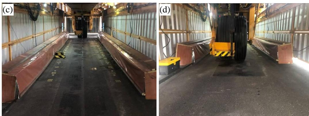
Figura 7 – Simulador de tráfego do tipo HVS (Elaboração própria, 2022)
