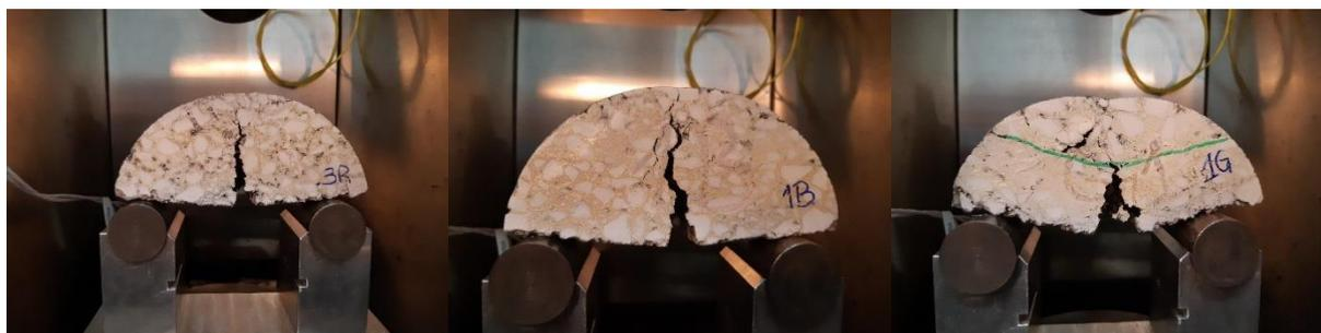
Figura 5. a) à esquerda: amostra de referência; b) ao centro: amostra com asfalto borracha; c) à direita: amostra com geogrelha. A linha verde representa a localização da geogrelha na amostra. Fonte: autores.
