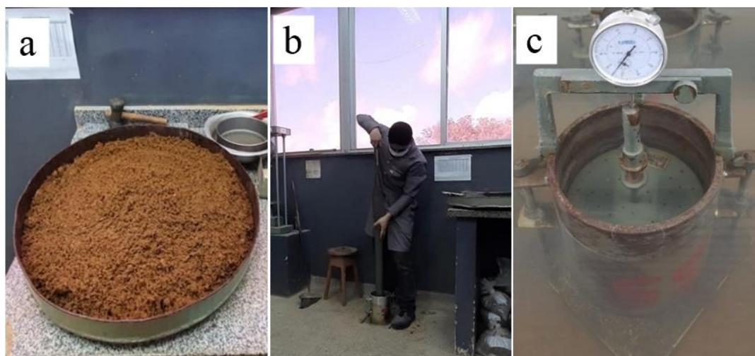
Figura 2. Compactação das misturas: (a) umedecimento e homogeneização da amostra; (b) compactação; (c) medição da expansão.
