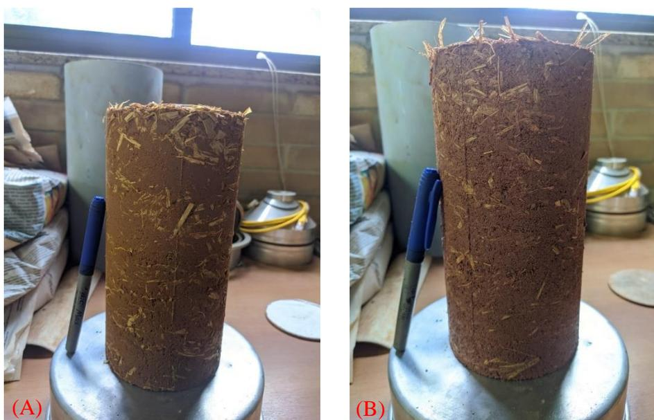
Figura 03. Corpos de prova moldados com fibra. (a) Km16\_FB (b) Km820\_FB.
