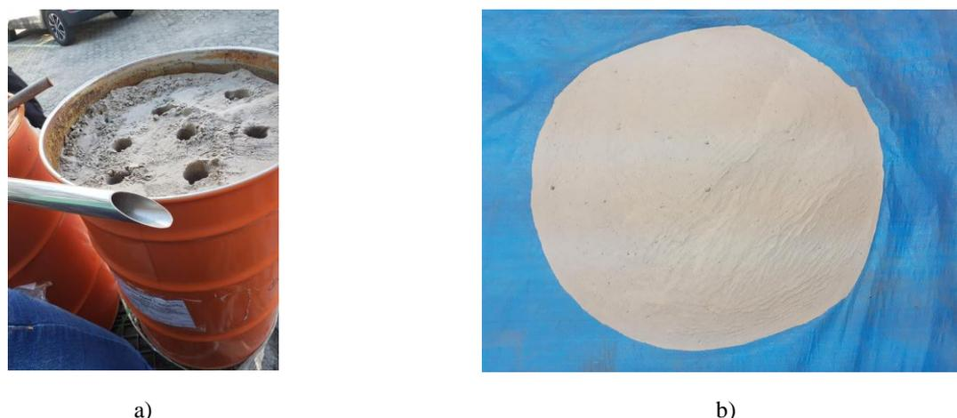
Figura 2 – Coproduto arenoso de mineração de ferro: a) acondicionado em tambores; b) amostra seca ao ar para realização de ensaios (Autores, 2022)
